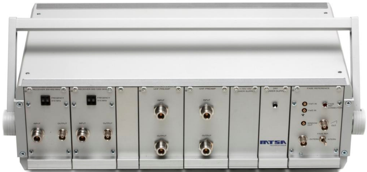
Meetsysteem met twee UHF ontvangers en twee voorversterkers
