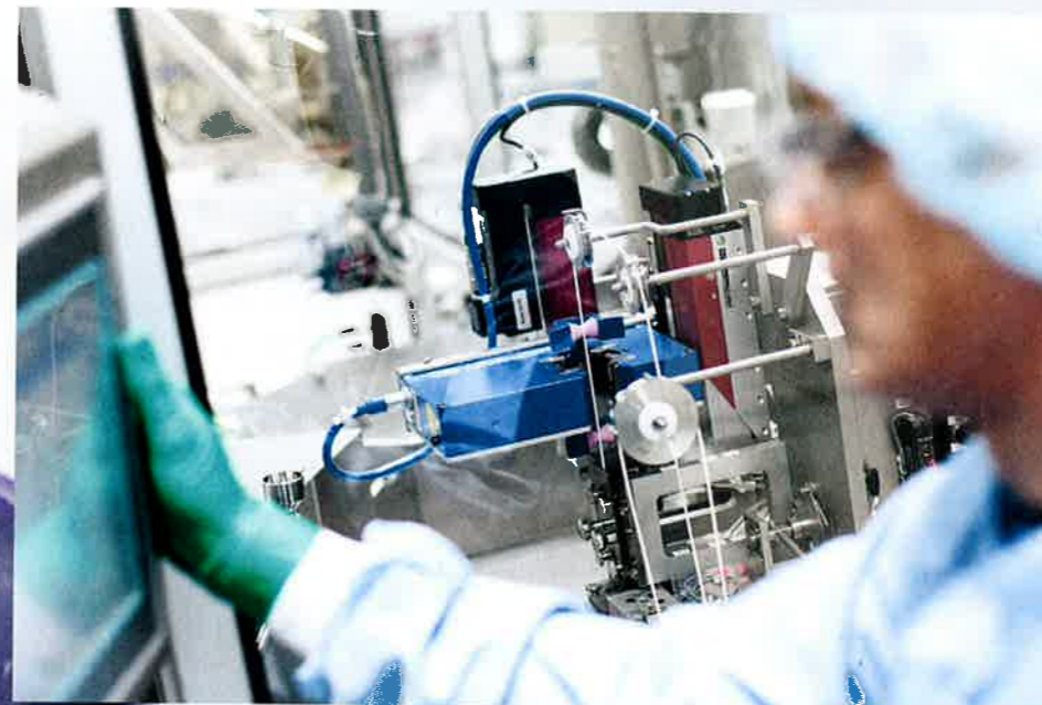
Het 'hart' van de nieuwe productiefaciliteit voor ImplanonNXT, waar de vezel met actieve stof tot staafjes van exact 4 centimeter wordt geknipt, die in de applicator worden geplaatst.
